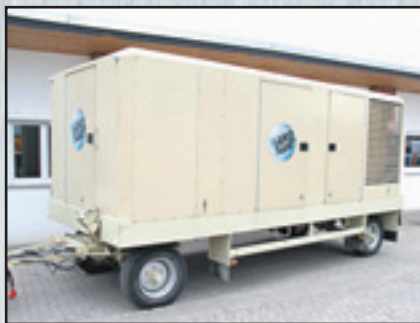
Kompressor Ingersoll Rand XHP 1170 , Baujahr 2007, 1730 Stunden, Caterpillar Dieselmotor, Volumen 33 m³, 25 bar, montiert auf 2-Achs Fahrgestell mit Druckluftbremse, Top Zustand ..... Preis auf Anfrage
