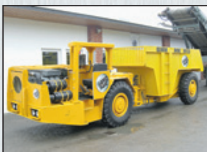
Tunneldumper GHH MKA 15 , Baujahr 1994, Stunden keine nach Überholung, Motor Deutz Diesel F 6 L 413 FW, 102 kW, Kessler Achsen, Getriebe Clark, Bereifung neu 14.00-24, Muldeninhalt 6,4 m³, einsatzbereit ..... Preis auf Anfrage
