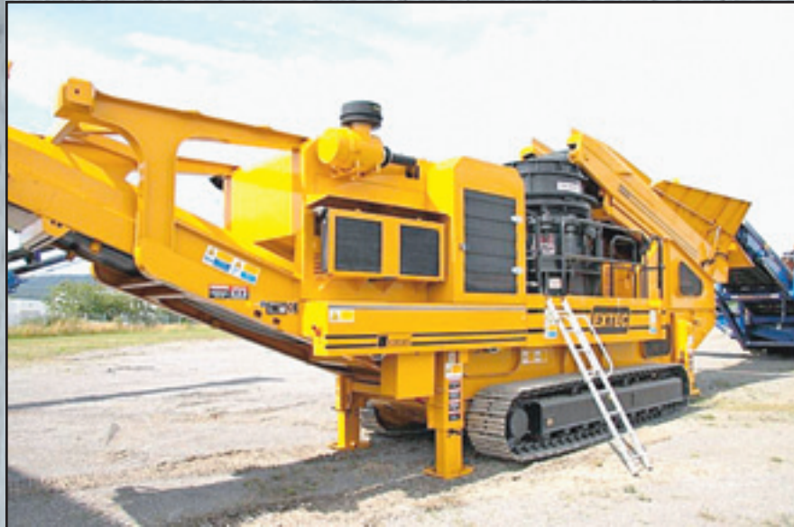
Backenbrecher Extec C 12 + , Baujahr 06/2008, 564 Stunden, Caterpillar Dieselmotor 1200 x 800 mmm Aufgabemaß, Vorabsiebung, seitliches Ausstragsband, langes Hauptband, hohe Bunkerwände mit Hardox Verschleißplatten, Magnetabscheider, Top Zustand ..... Preis auf Anfrage
