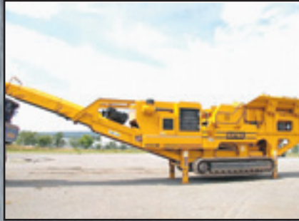
Backenbrecher Extec C 12 + , Baujahr 06/2008, 564 Stunden, Caterpillar Dieselmotor 1200 x 800 mmm Aufgabemaß, Vorabsiebung, seitliches Ausstragsband, langes Hauptband, hohe Bunkerwände mit Hardox Verschleißplatten, Magnetabscheider, Top Zustand ..... Preis auf Anfrage
